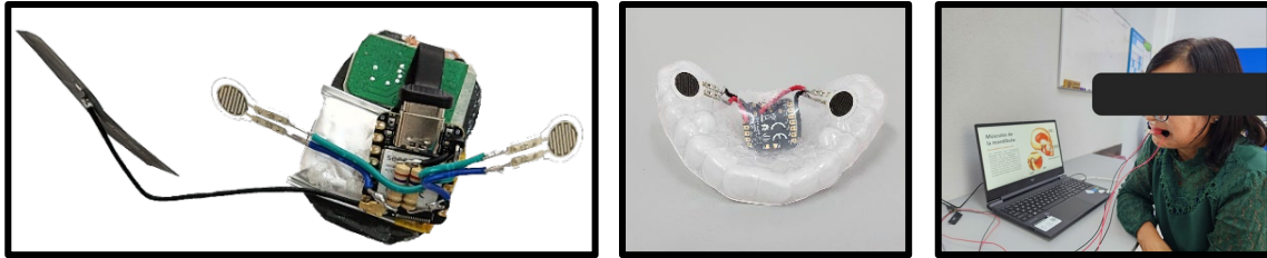
Figura 1. Prototipo biomecatrónico para medición de bruxismo inalámbrico y medición alámbrica de una voluntaria con bruxismo
