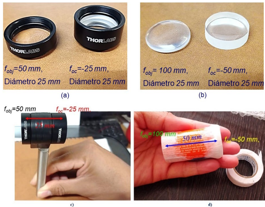
Figura 4. a) Lentes marca Thorlabs, b) Lentes de resina generadas mediante manufactura aditiva, c) Instrumentación de Telescopio con lentes y montura Thorlabs, d) Instrumentación de Telescopio con lentes de resina y tubo de material accesible
