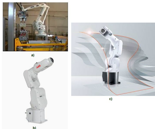
Figura 2. Robots manipuladores de uso industrial. a) Robot RP40 Tecno, b) Robot KUKA KR 4 AGILUS, c) Robot ABB IRB 1100
