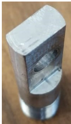
Figura 8. Indentador rectangular de 2.97mm de ancho x 9.97mm de largo
