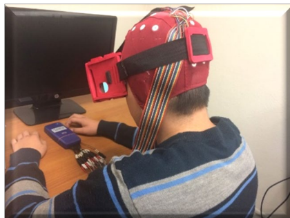
Figura 6. Uso del equipo de EEG y HMD durante el experimento
