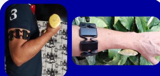
Figura 1. Myo-Armband conectada en músculo del Tríceps y Antebrazo
