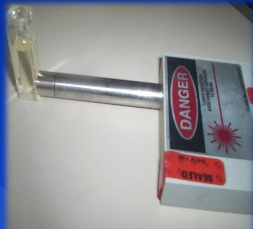
Figura 22. Medición del Biofilm con Raman
