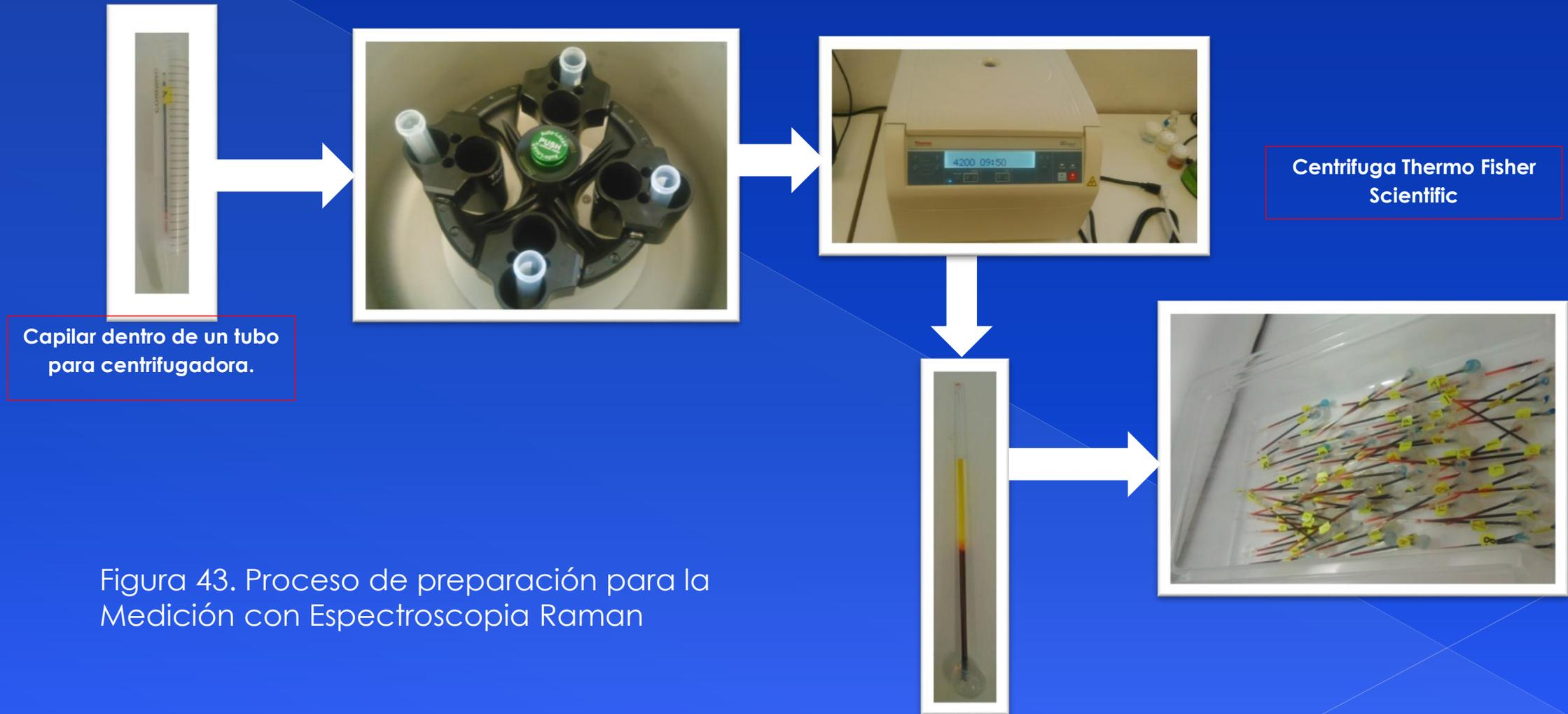
Figura 43. Proceso de preparación para la Medición con Espectroscopia Raman
