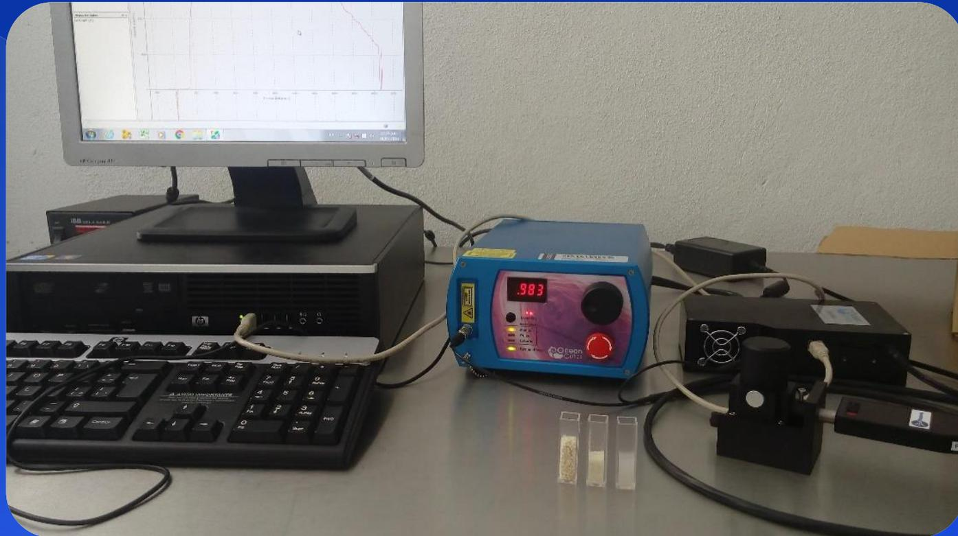
Figura 3. Arreglo experimental del equipo Raman
