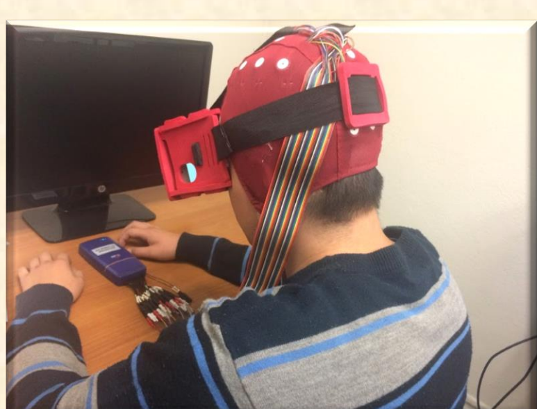
Sujeto con el equipo de EEG y el visor sujeto a la cabeza (HMD) durante el experimento.
