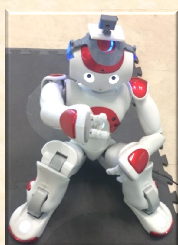
Robot Nao en una habitación aparte, respondiendo de acuerdo a las señales de EEG.
