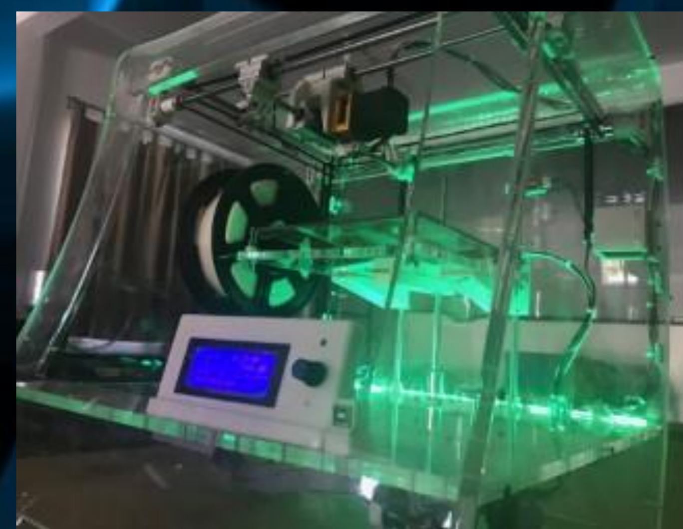
Fig.3 Impresora de extrusión tipo Cartesiana hecha en México
