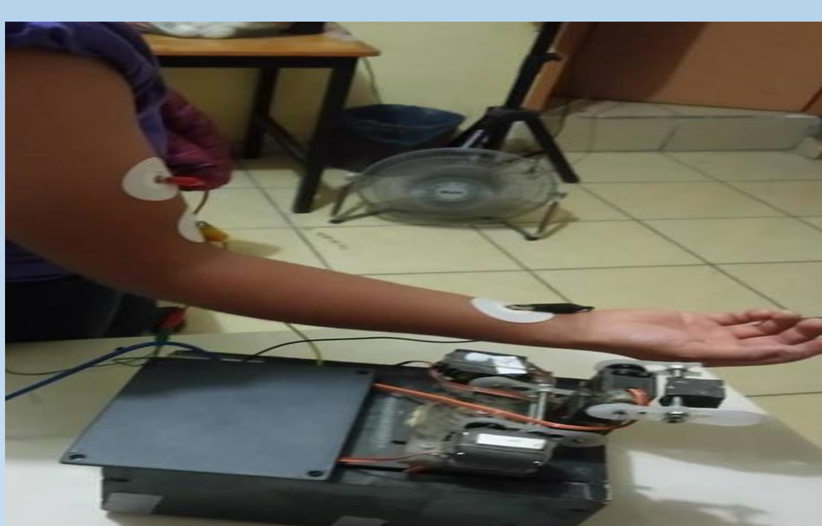
Figura 6. Servomotor en posición del miembro relajado.
