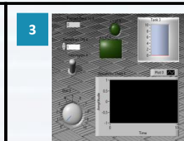
Figura 7 Temporizador, alarma visible.
