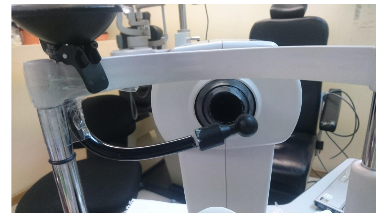
Figura 1. Aditamento colocado al Topógrafo para la obtención de las medidas.
