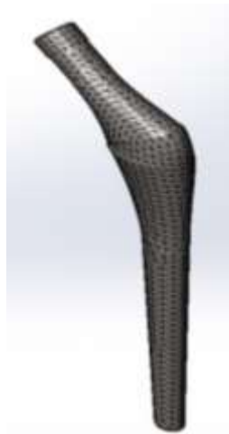
Figura 3. Modelo mallado del vástago
