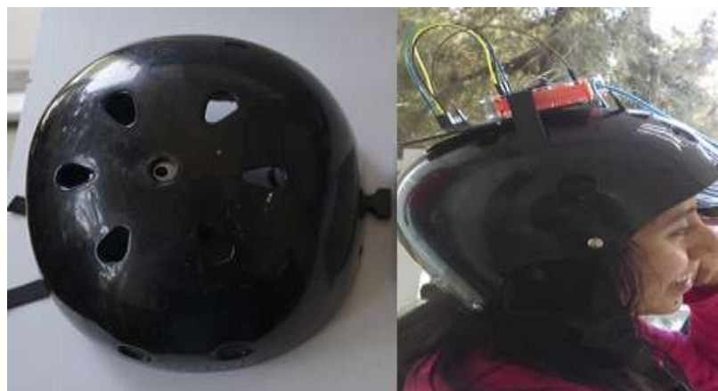
Fig. 5. Montaje del sistema de detección de movimientos en el casco.
