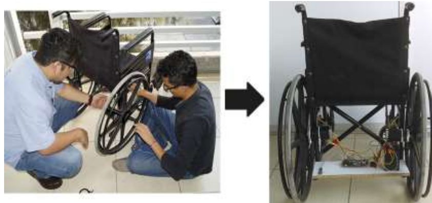
Fig. 6. Instalación del sistema de control en la silla de ruedas.
