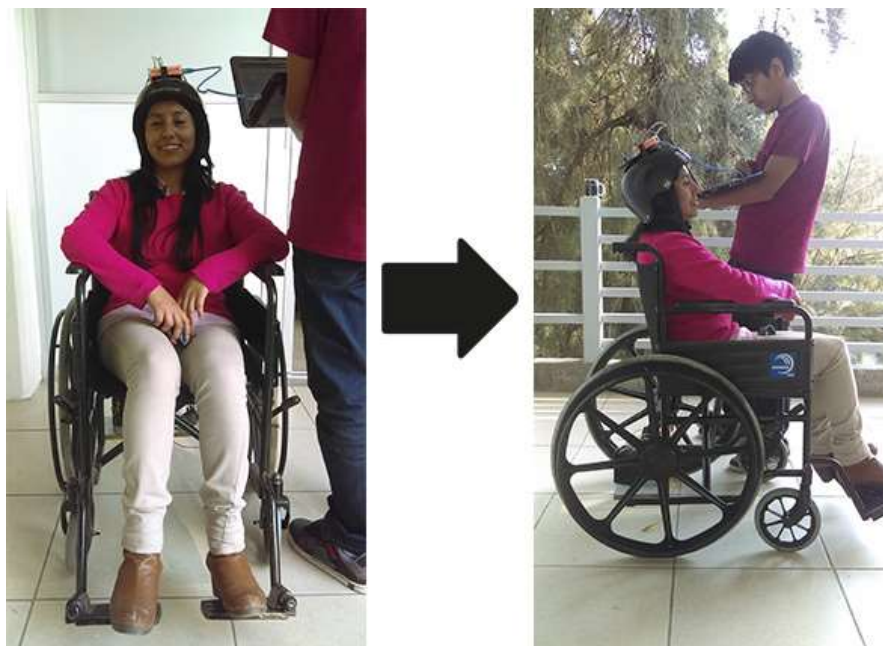
Fig. 7. Sistema de control adaptado a la silla, con sujeto de prueba.
