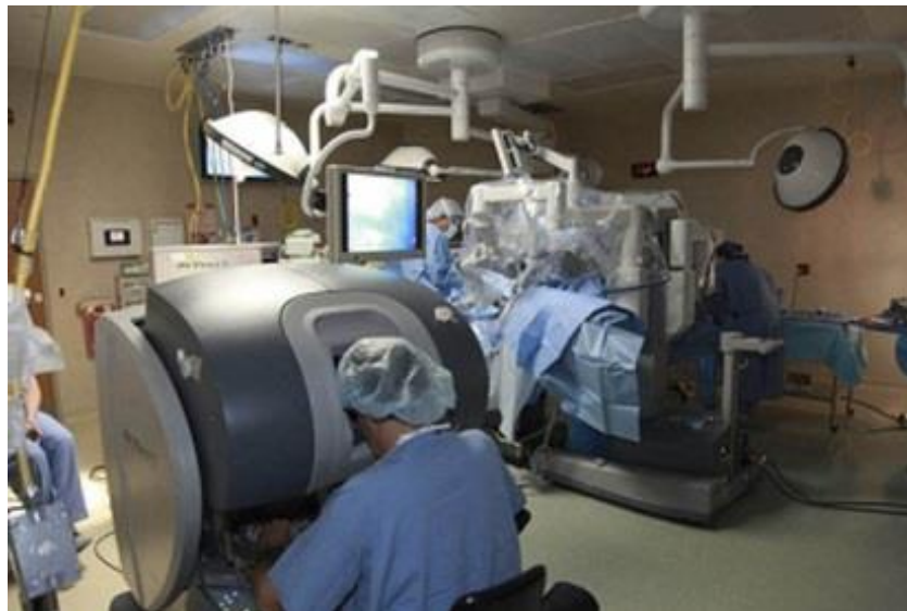
Figura 2. El robot Da Vinci es un sistema robótico que se maneja como maestro esclavo de donde el médico cirujano es el maestro que realiza la cirugía y los brazos robóticos son los esclavos. Fue diseñado y fabricado por la empresa Intuitive Surgical, presentado en el año 1999 pero aprobado en el año 2000 por la Administración de Alimentos y Medicamentos (FDA) en los Estados Unidos [4].
