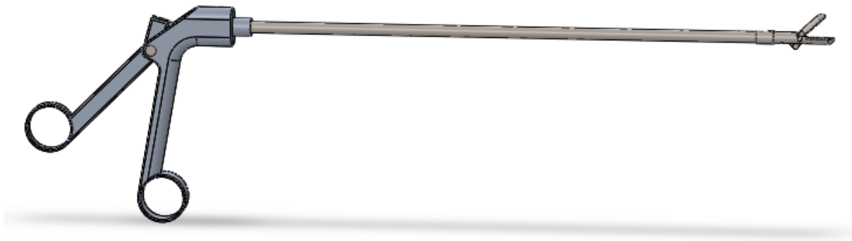
Figura 3. Diseño de la pinza laparoscópica utilizando SOLIDWORKS.
