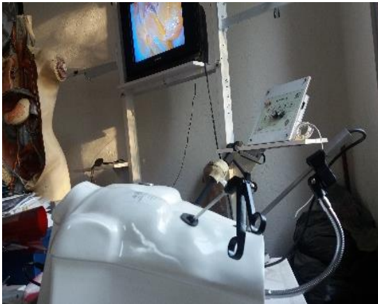
Figura 8. a) Simulador de cirugía con la imagen de la videocámara proyectada en una televisión. b) Se introduce la pinza dentro del simulador.
