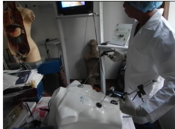
Figura 8. a) Simulador de cirugía con la imagen de la videocámara proyectada en una televisión. b) Se introduce la pinza dentro del simulador.
