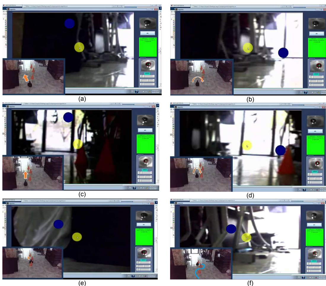
Figura 9. Movimiento de un vehículo de prueba a través del seguimiento y localización de la pupila.
