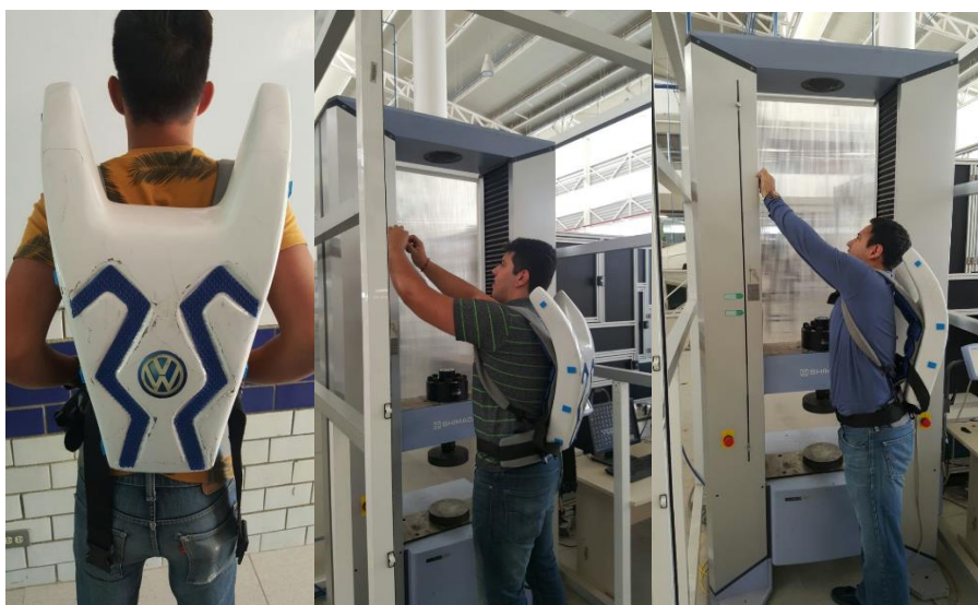
Figura 3. Vistas de los participantes en la prueba realizando movimientos con el modelo "misma forma y peso" del exoesqueleto de tronco superior.
