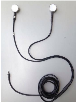
Fig. 3 Transductor diferencial diseñado en la Universidad Iberoamericana Puebla.
