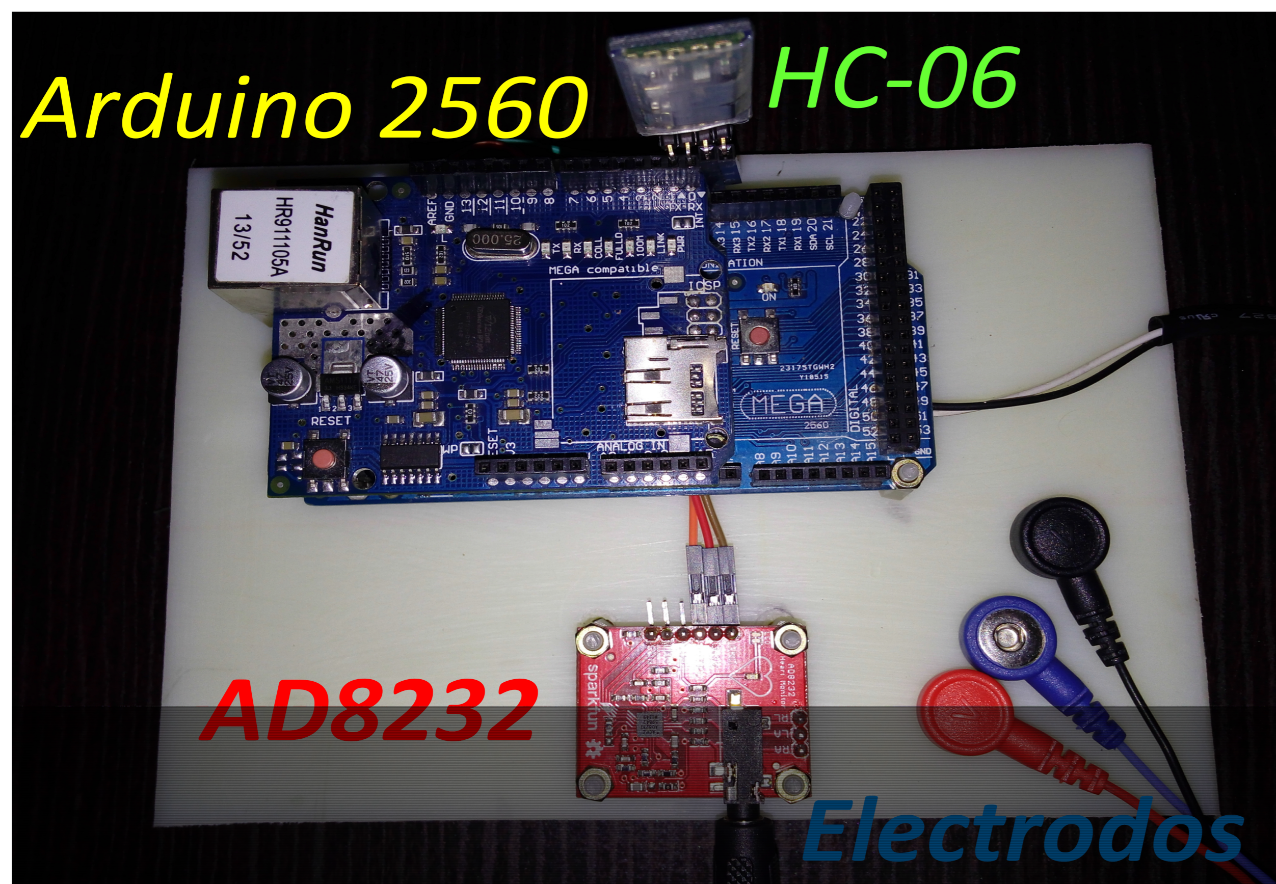
Fig.2: Prototipo del dispositivo de monitoreo de señales cardiacas.
