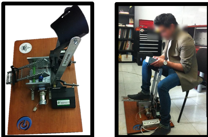
Figura 8. Sistema de rehabilitación motriz del tobillo (prototipo a escala real).
