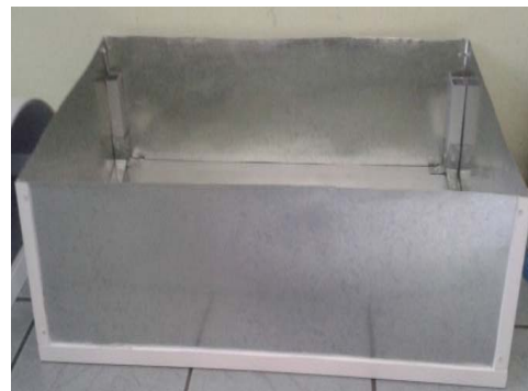
Figura 2. Construcción del prototipo cuyas dimensiones son: 62.5 x 42.5 x 65 cm.
