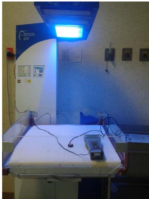
Figura 6. Equipo de fototerapia basado en lámparas fluorescentes.
