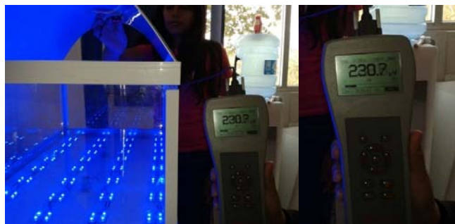
Figura 5. Potencia óptica reflejada por el domo, parte superior de la cuna (0.230mW).
