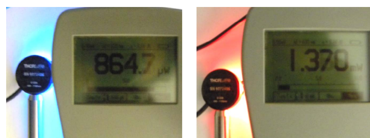
Figura 2.- Medición de la potencia óptica de las fuentes de luz LED.
