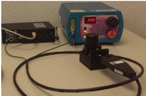
Figura 1. Arreglo de la instalación del espectrómetro.
